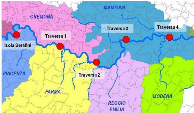
Planimetria del tratto in studio con ubicazione delle n. 4 traverse di regolazione dei livelli di magra del fiume Po
