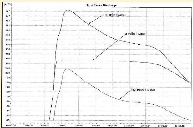
Figura 10 – Invaso di Senago: idrogrammi di piena T=100 anni assetto di progetto.
