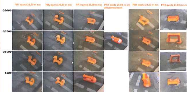
Fig. 15 - Confronto planimetrico buche di erosione per gli scenari sperimentati
