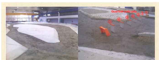
Fig. 9 - Modello con fondo mobile realizzato
